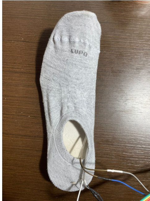
Figura 30: Conjunto (palmilha e sensores) acomodado dentro de meia
