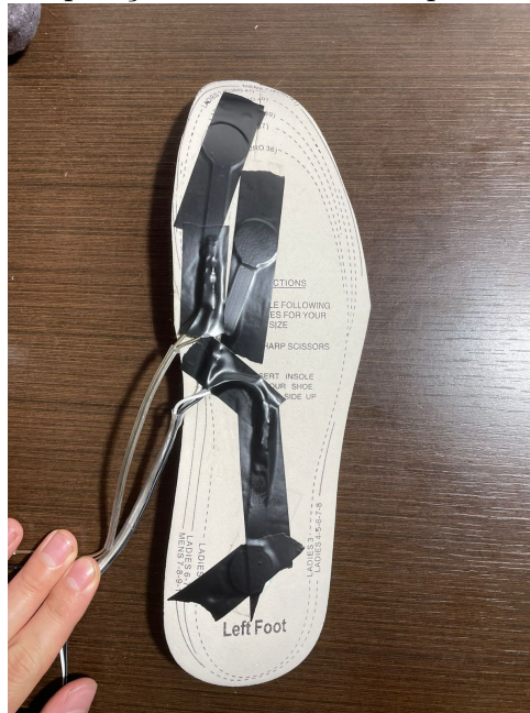
Figura 29: Disposição dos sensores na palmilha recortável
