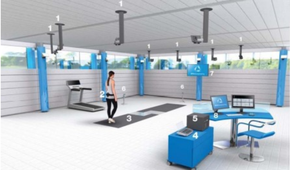
Figura 7: . Exemplo de um sistema NWS: (1) câmeras infravermelhas; (2) sensor inercial; (3) sensor FS de força; (4) sensor eletromiográfico wireless; (5) estação de trabalho; (6) sistema de gravação de vídeo; (7) TV; (8) estação de controle.
